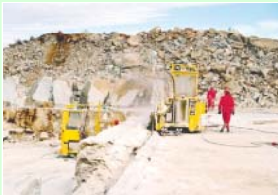
Vuolukiveä louhitaan ketjusahoilla, joilla sahataan sekä pystyettä vaakasuoraan, jolloin saadaan irrotetuksi koko louhimon levyinen letka. Kivilohkit irrotetaan letkasta pyöräkuormaajalla. Sivukiveä poistetaan räjäyttämällä.
