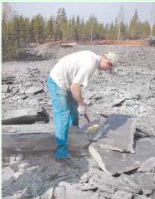
Liuskekivi irrotetaan kaivinkoneella. Liuskekivilaatat lohkotaan käsityönä.
